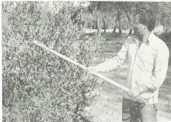
תמונה 3. "מסרק" מיכאני הנישא ביד ומנתק את הפרי ע"י פעולת סריקה מתנודדת של ענפים.
