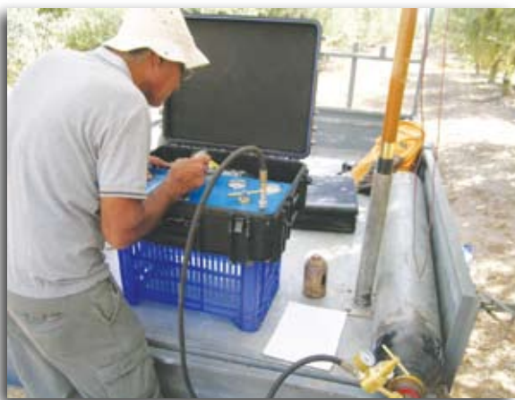
תמונה 2: מדידה של פוטנציאל המים בעץ באמצעות תא לחץ
