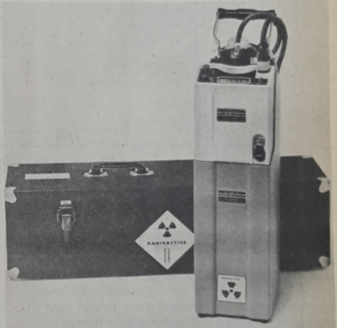
מד צפיפות הקרקע בעומק — דגם קומפקטי DUC-37. המכשיר מוצב על אותו צינור גישה של מפזר הניטרונים. יחידת המנייה הספרותית זהה וחליפית.
