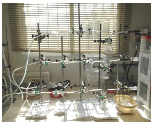
תמונה 2: מערכת איסופי אוירה טורית. בכל כלי זכוכית חיפושית בודדת.
